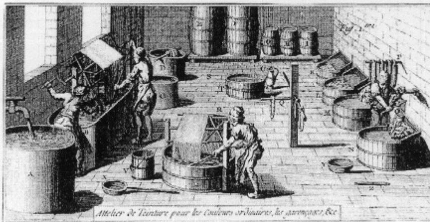
Atelier de garançage (Jean-Marie Roland de la Platrière. L'art du fabricant de velours de coton...suivi d'un traité de la teinture et de l'impression des étoffes, Paris, 1780).
